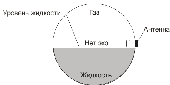
Рис.10 Калибровка по скорости звука и типу жидкости возможна как при наличии, так и отсутствии эхо-сигнала
